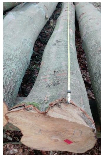
Ryc. 9. Pomiar długości sztuki drewna z pominięciem rzazu podcinającego
